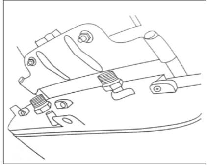
5. 从车身顶盖上拆下顶置空调器支架固定螺栓，拆下顶置空调器。
